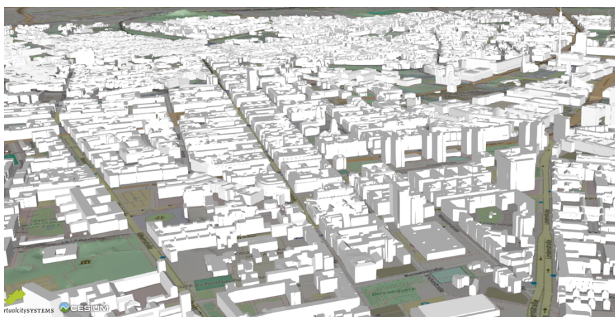
Obr. 3.6 Model mesta Berlín zobrazený pomocou webovej platformy CesiumJS a formátu glTF (Zdroj: virtualcitySYSTEMS)
