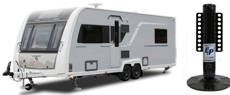
Obrázek 2.3: Systém E&P Caravan Level s výsuvnými podpěrami [9]
