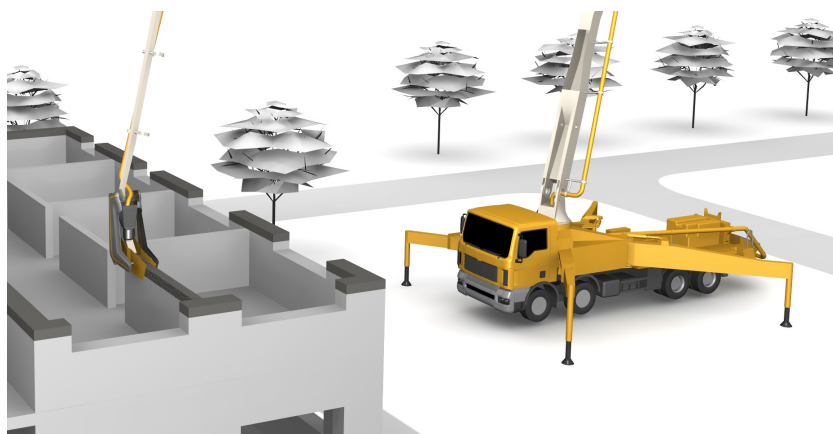
Obrázek 2.12: Stavební 3D tiskárna CONPrint3D [23]
