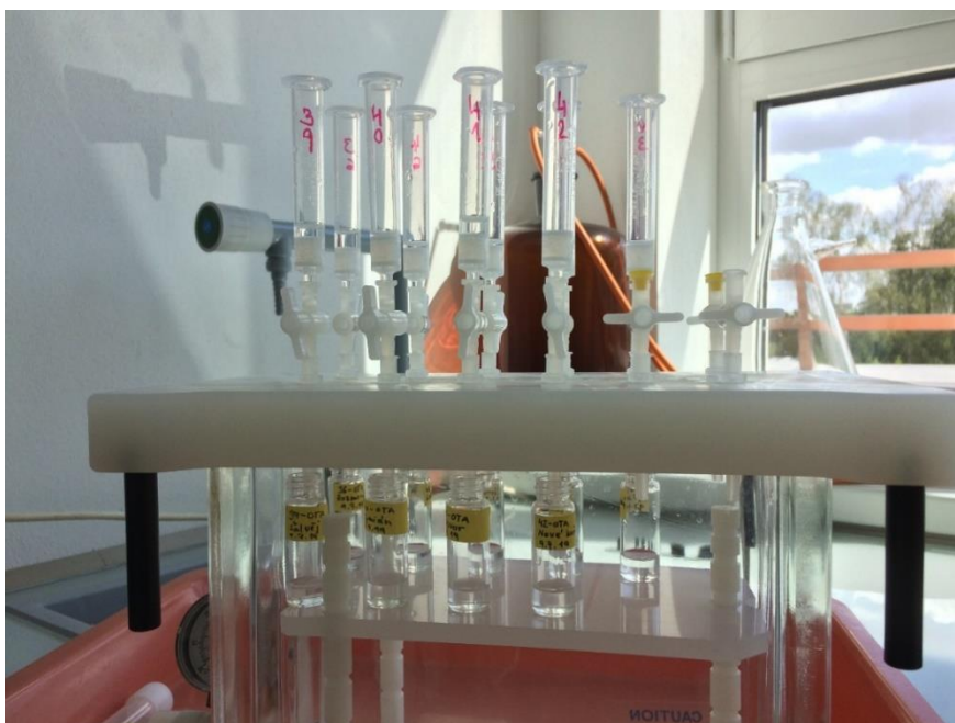
Obrázek 12: Eluce OTA metanolem.
