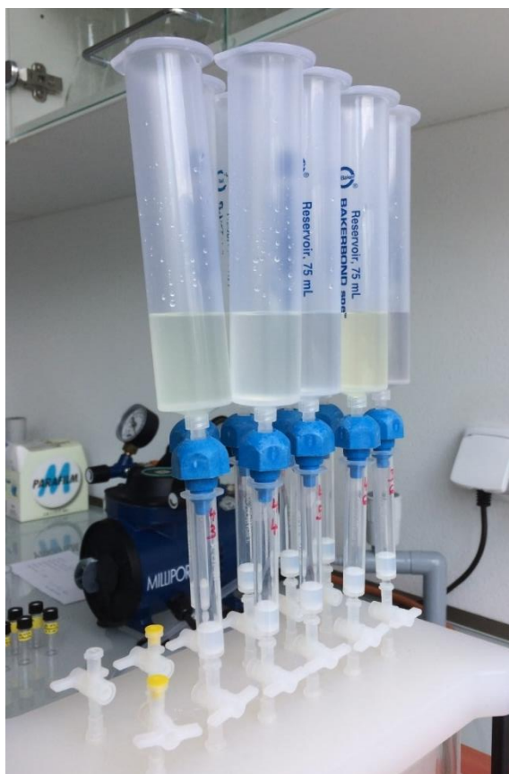
Obrázek 11: Kolonky s násadcem naplněné pufrům PBS.
