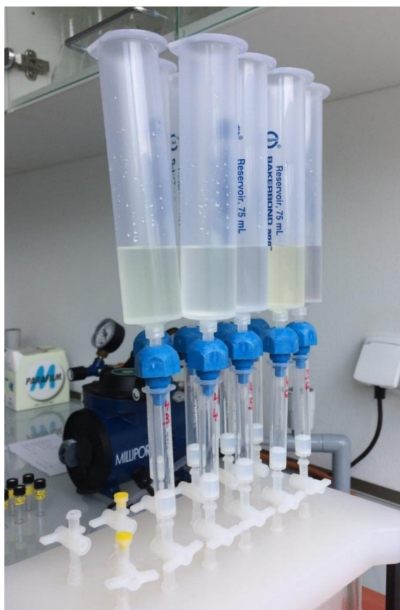
Obrázek 11: Kolonky s násadcem naplněné pufrům PBS.
