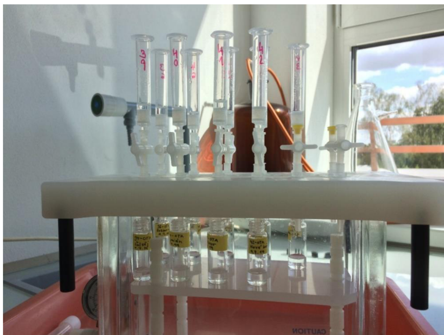
Obrázek 12: Eluce OTA metanolem.
