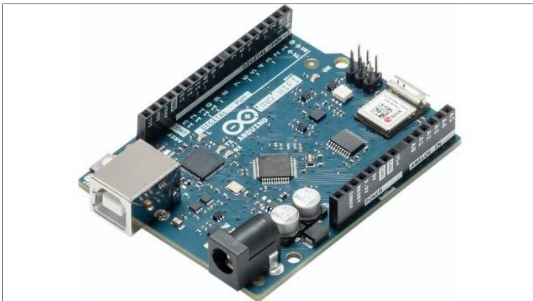
Obrázek č. 5 – Arduino UNO Wi-fi Rev2 [26]
