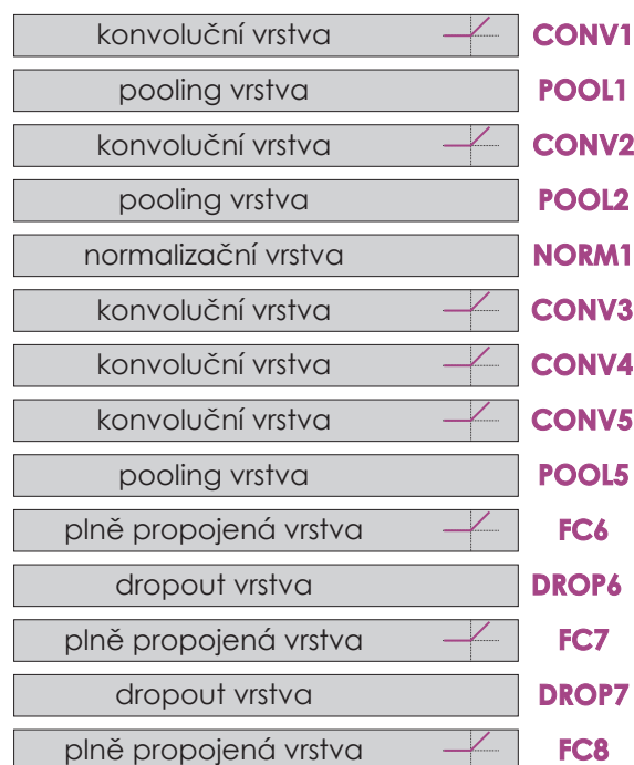
Obrázek 4.4: Struktura hluboké neuronové sítě pro detekci automobilů.
