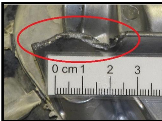
Obr. 10 Ulomená část odlitku [10]
