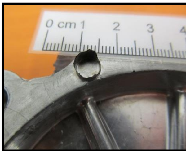
Obr. 16 Zateklina do vyhazovačů [10]
