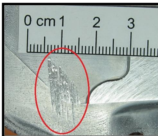
Obr. 9 Nesprávně odstřížený odlitek [10]
