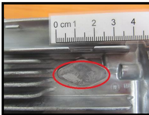
Obr. 13 Drsný povrch odlitku [10]
