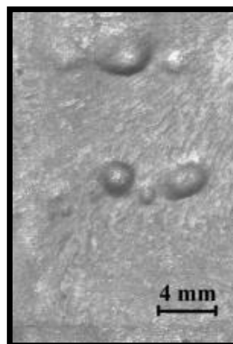
Obr. 35 Zahlčený vzduch na povrchu odlitku [26]
