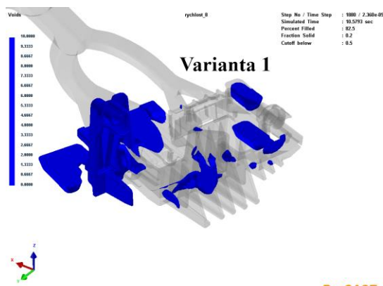
Obr. 99 Uzavřený vzduch u varianty 1 v místě B
