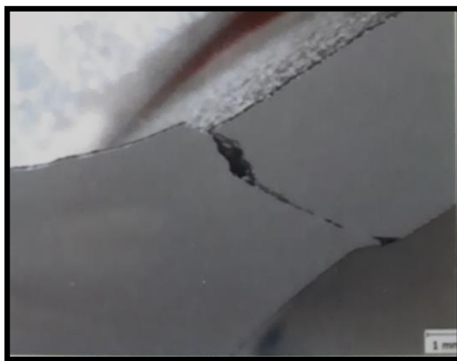
Obr. 26 Prasklina vzniklá při vyjímání odlitku z formy [10]
