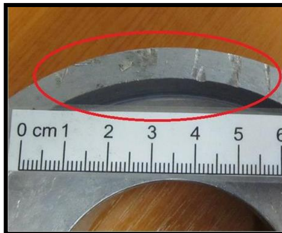
Obr. 8 Omačkaný a potlučený odlitek [10]
