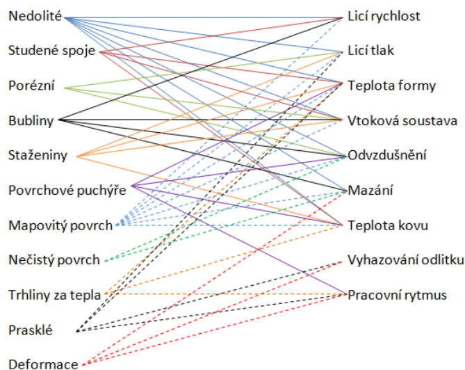
Obr. 5 Savenův diagram příčin vzniku vad při tlakovém lití [8]
