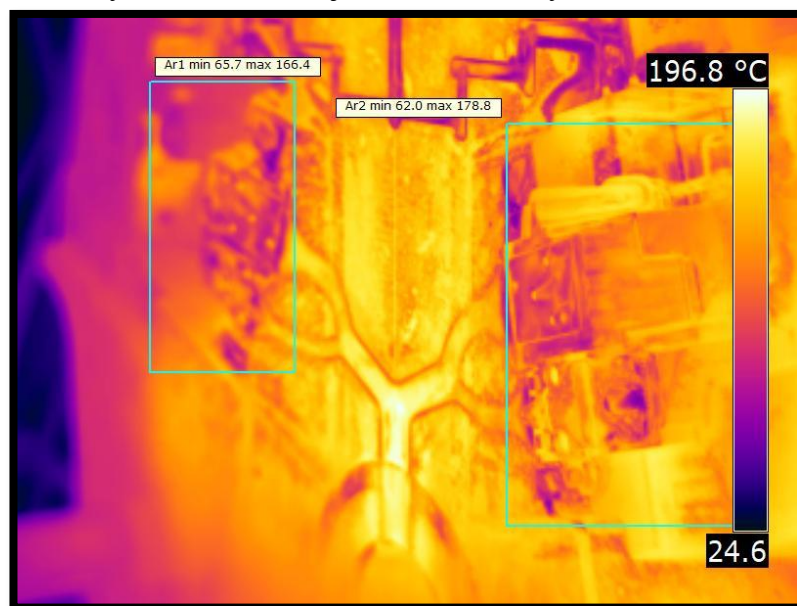
Obr. 61 Snímek teplotního rozložení pevné formy po postřiku
