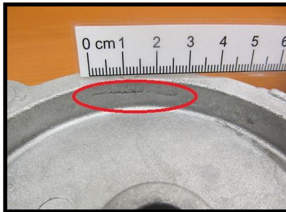
Obr. 20 Odloupnutá vrstva materiálu [10]
