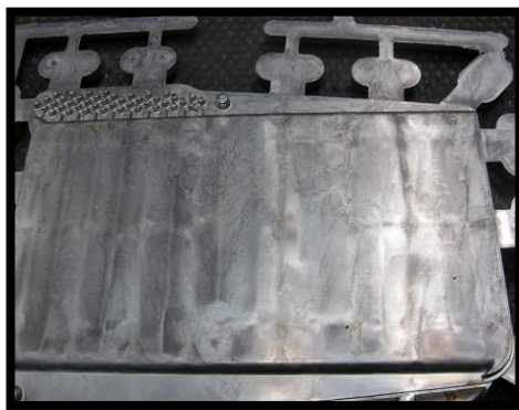
Obr. 18 Mapovitý povrch odlitku [10]
