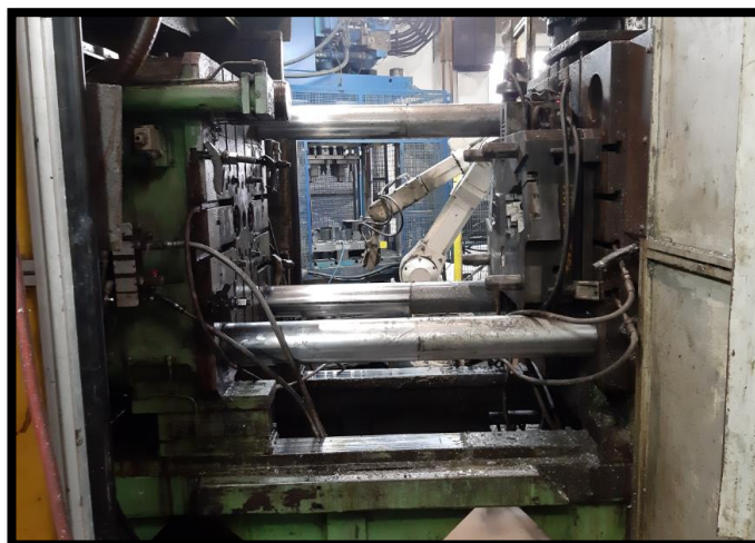
Obr. 47 Tlakový licí stroj, manipulační robot a ostříhovací stroj
