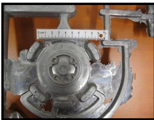
Obr. 15 Zateklina do dělicí roviny [10]
