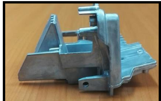
Obr. 102 Odlitek varianta 2 (vada potlačena)
