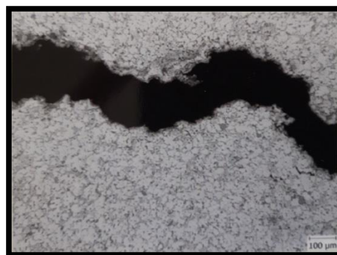
Obr. 25 Metalografický výbrus vnitřní trhliny [10]
