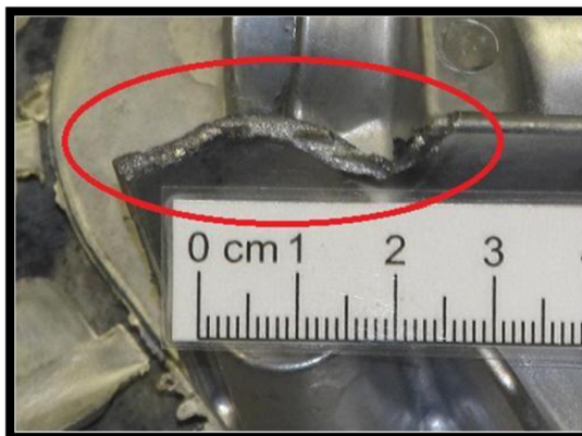
Obr. 10 Ulomená část odlitku [10]
