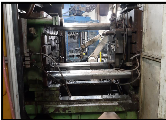
Obr. 47 Tlakový lící stroj, manipulační robot a ostříhovací stroj
