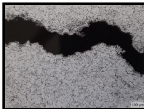
Obr. 25 Metalografický výbrus vnitřní trhliny [10]
