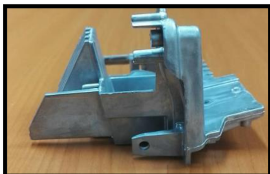
Obr. 102 Odlitek varianta 2 (vada potlačena)
