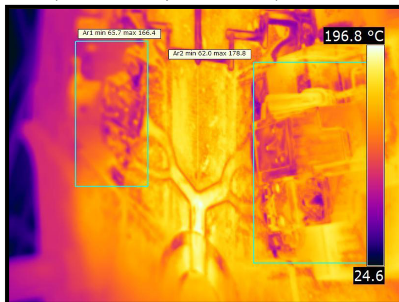
Obr. 61 Snímek teplotního rozložení pevné formy po postřiku
