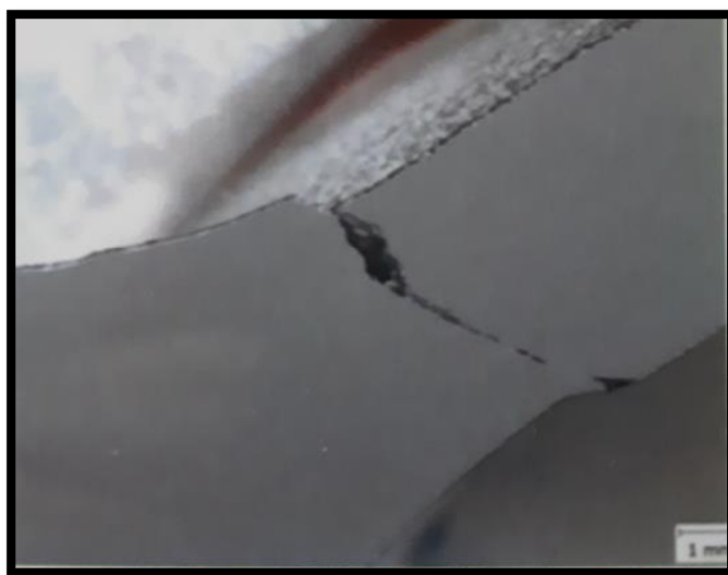
Obr. 26 Prasklina vzniklá při vyjímání odlitku z formy [10]
