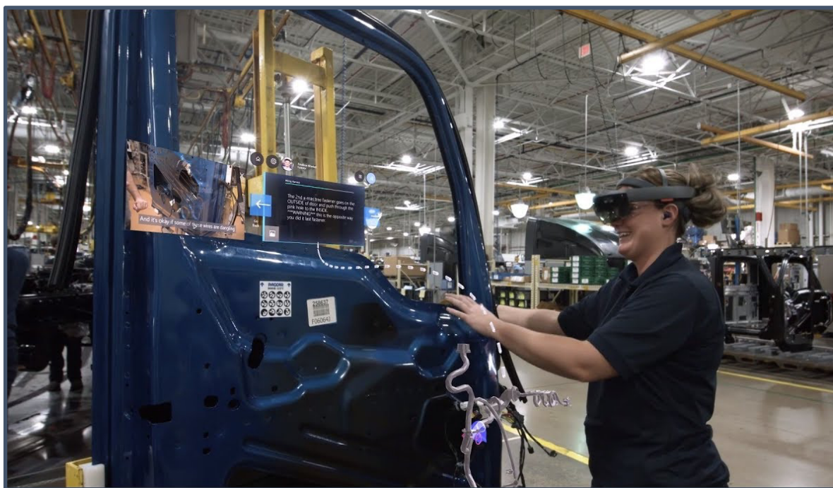
Obrázek 6: Využití brýlí rozšířené reality pro kontrolu kvality
