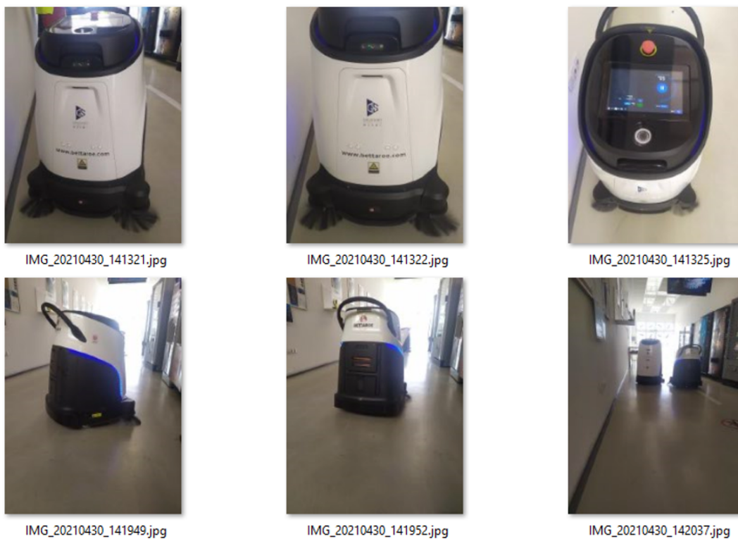
Obrázek 10: Autonomní mycí vůz firmy Gaussian Robotics
