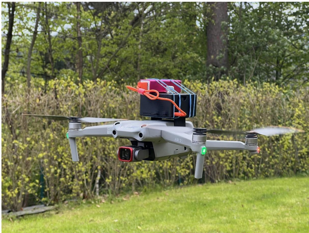
Obr. 16 Dron s připevněnou měřící sestavou
