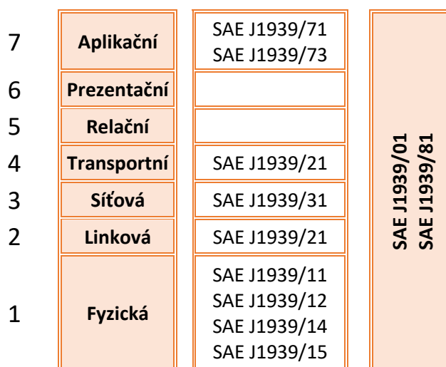
Obrázek 9 - Model ISO/OSI SAE J1939
