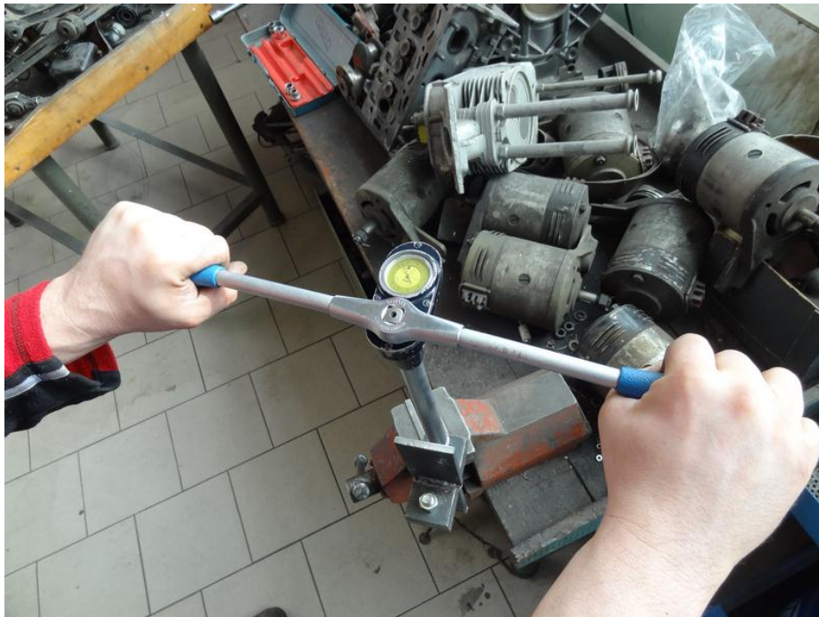
Obr. 31 – Utahování šroubového spoje vypočítaným utahovacím momentem
