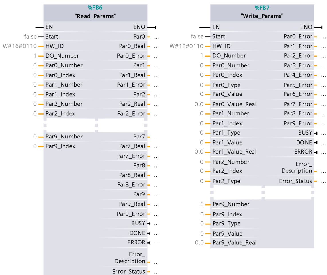
Obr. 5.2: Vstupně/výstupní rozhraní bloku Read_Params a Write_Params
