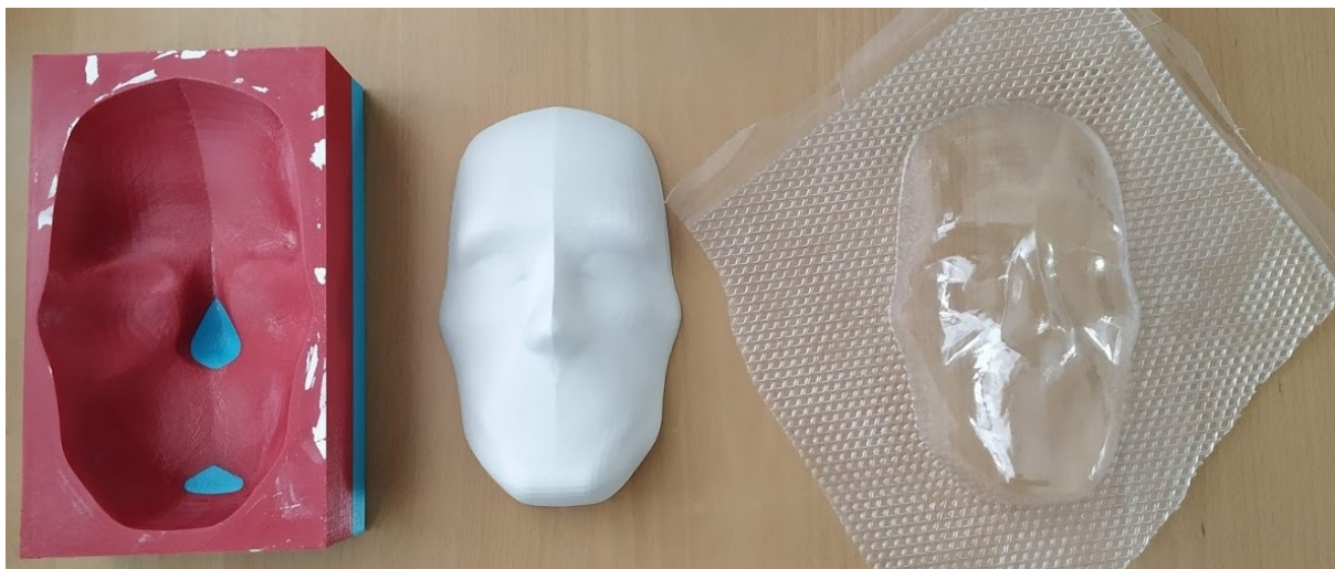
Obrázek 4.1: Forma pro sádrový odlitek, sádrový odlitek, zformovaná maska [autor]
