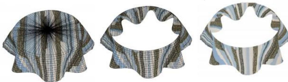
Obr. 5 Hodnocení splývavosti pomocí software 3Dscan [17]
