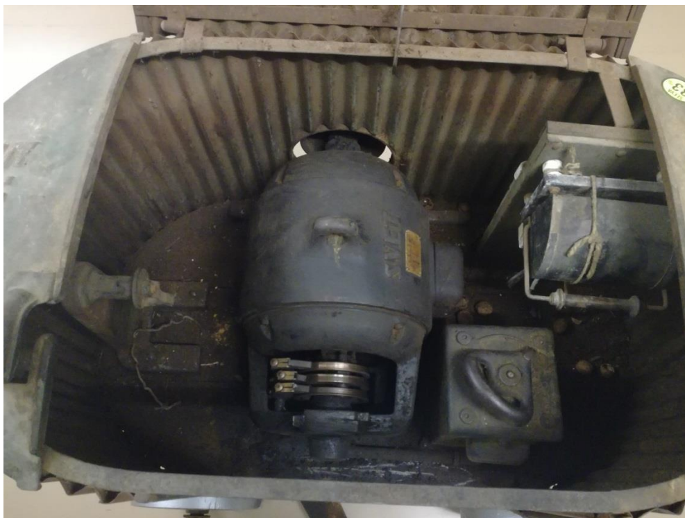
Obrázok 3.3: Elektromotor SVET pred renováciou
