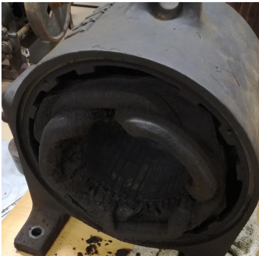
Obrázok 3.10: Stator elektromotora SVET pred čistením
