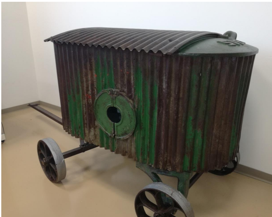
Obrázok 3.12: Podvozok a skriňa pohonu SVET po renovácii
