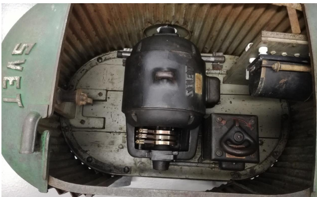
Obrázok 3.13: Elektromotor SVET po renovácii
