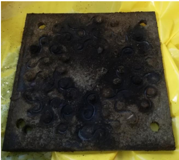
Obrázok 3.6: Azbestová doska zo spúšťača pred čistením a po čistení
