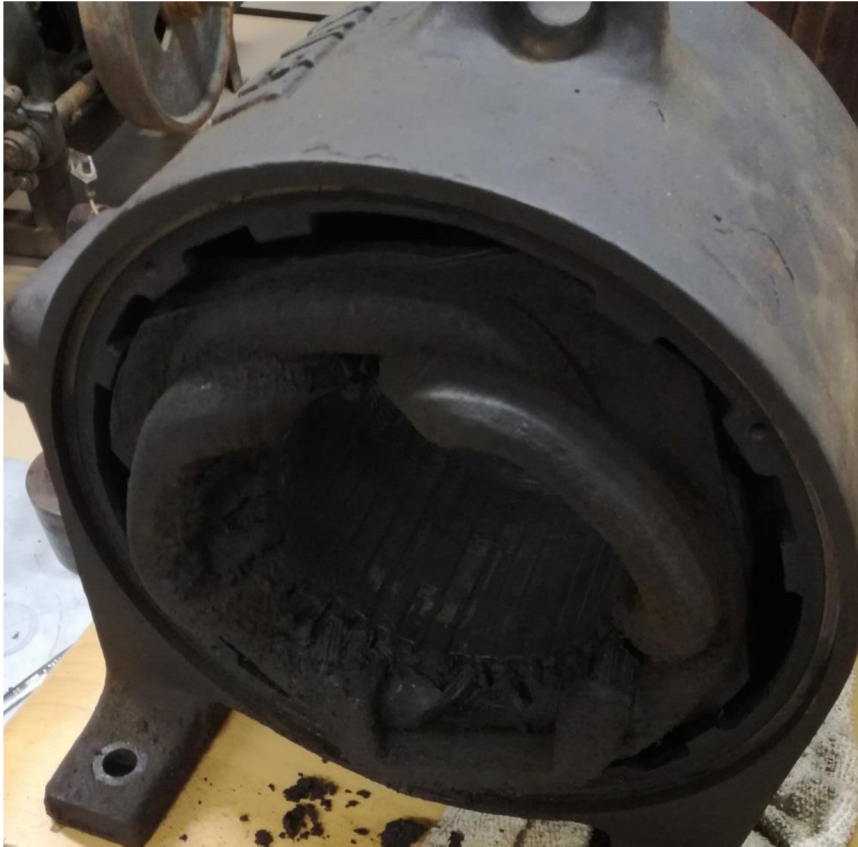
Obrázok 3.10: Stator elektromotora SVET pred čistením
