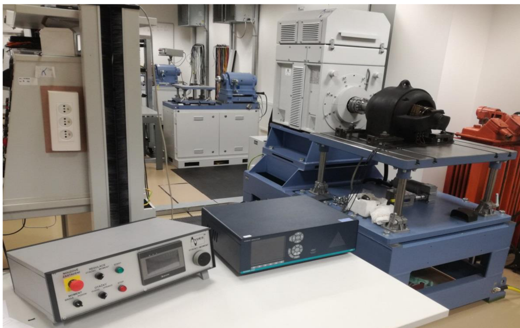
Obrázok 4.5: Meranie parametrov motora na dynamometri, potrebných pre výpočet strát v železe statora
