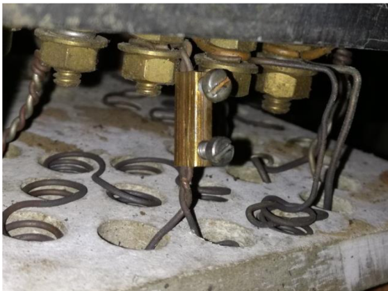
Obrázok 3.7: Mosadzná spojka použitá na spojenie odporového drôtu v odporovom spúšťači
