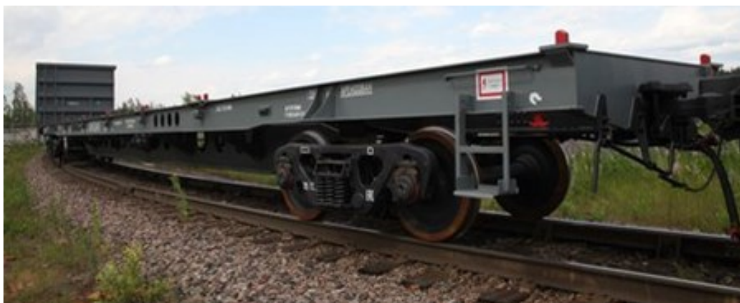
Obr. 7.: Nízkopodlažní vůz pro přepravu standardních kontejnerů Zdroj: [4]
