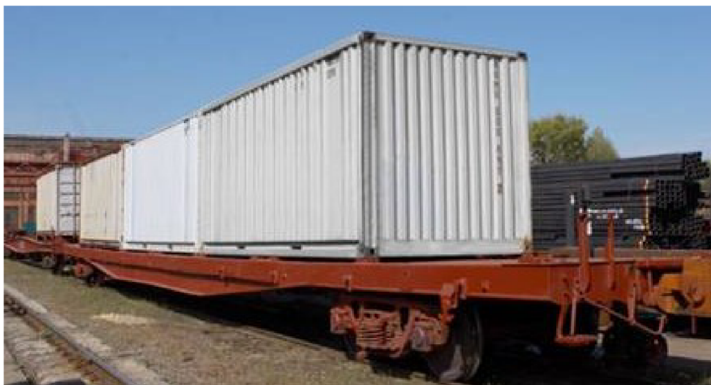
Obr. 6.: Nízkopodlažní vůz pro přepravu těžkých kontejnerů
