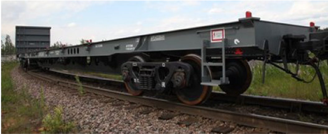
Obr. 7.: Nízkopodlažní vůz pro přepravu standardních kontejnerů Zdroj: [4]
