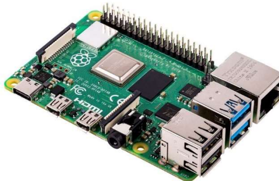
Obrázok 3.1: Raspberry PI 4B[42]
