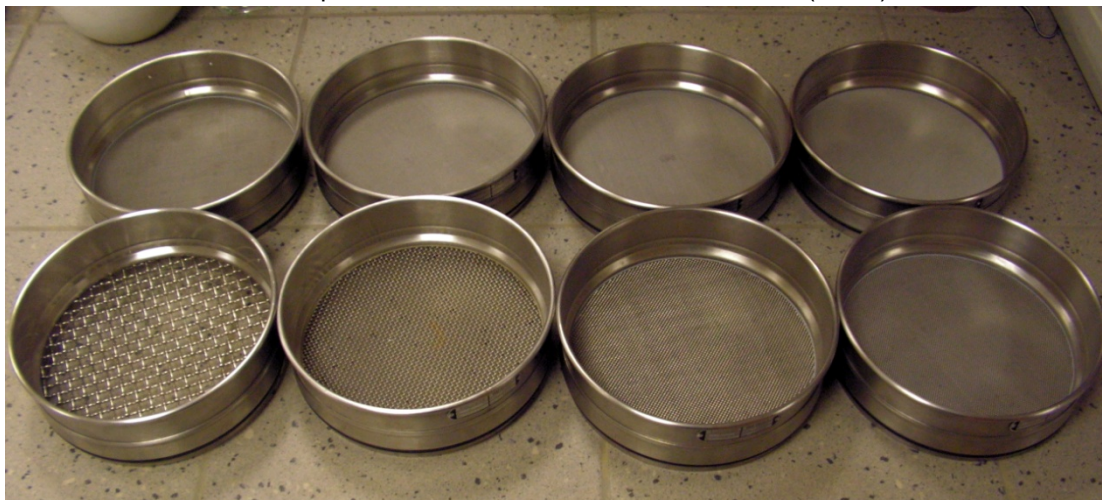
Obr. č.: 4. Sada sítí určená pro síťovou metodu zrnitostního rozboru. (Autor)
