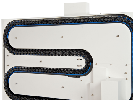
Obr. 2a.) Diskový zásobník Haas [10] b.) Kruhový zásobník Haas s výklopným lôžkom [11] c.) Reťazový zásobník Gifu [12]
