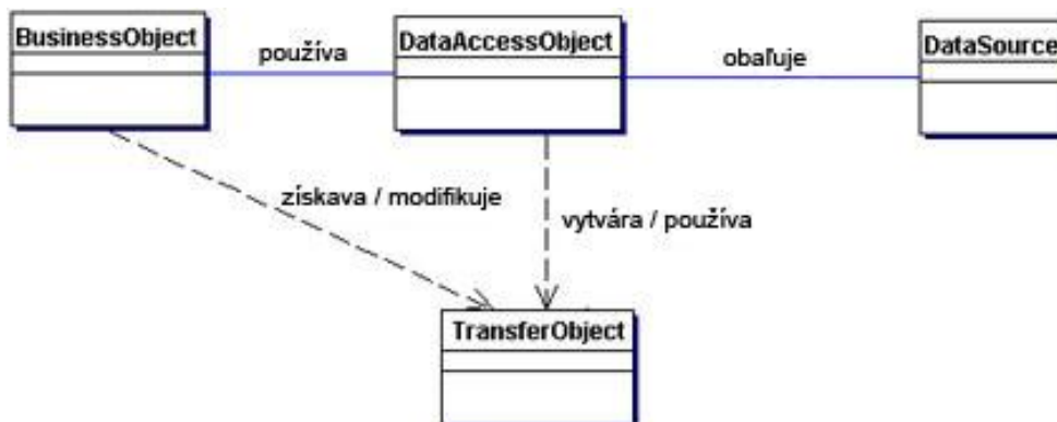
Obrázok 2.7: Architektúra využívajúca DAO. Obrázok prebraný z [17].
