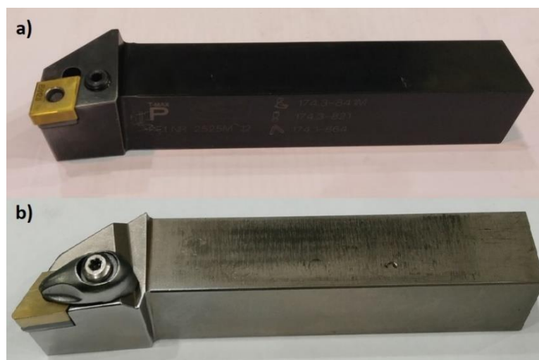
Obr. 2.2 Použité držáky: a) držák na VBD z KNB s označením PCLNR 2525M 12, b) držák na VBD z řezné keramiky s označením DDNR 2525.
