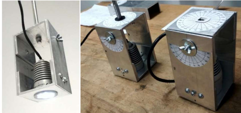
Obr. 49 a) Svítidlo v kulovém integrátoru b) Konstrukce pro natáčení svítidel
