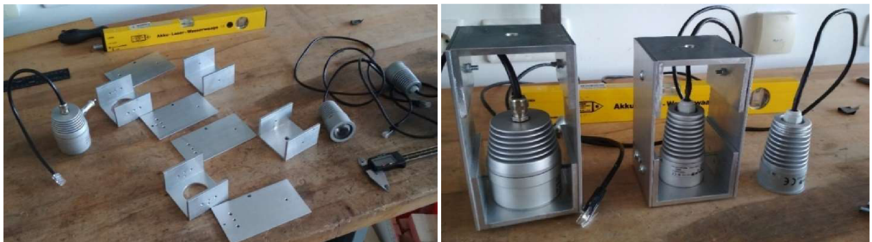
Obr. 39 a) Hliníkové díly pro konstrukci svítidel b) Sestavená konstrukce se svítidlem
