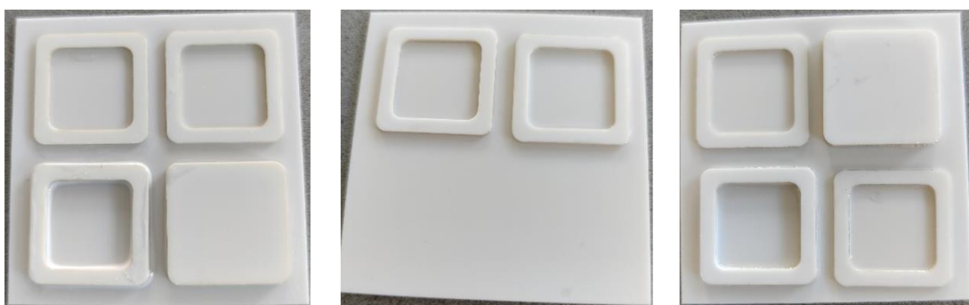
Obrázek 2.6 Připájené rámečky a víka na keramický substrát
