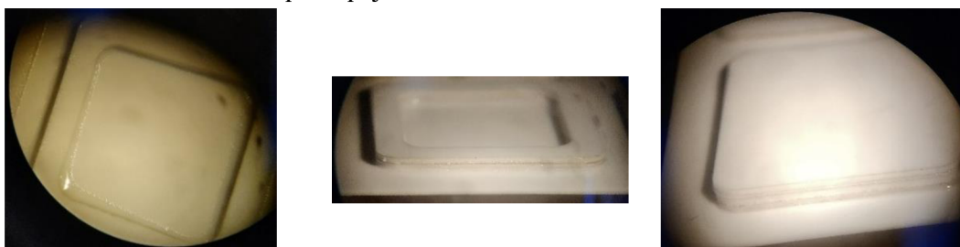
Obrázek 2.7 Kontrola připájených rámečků pomocí mikroskopu
