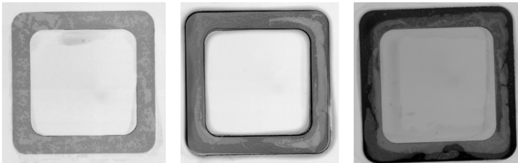
Obrázek 2.8 Kontrola rámečků připájených pájkou s nízkou hustotou pomocí rentgenu
