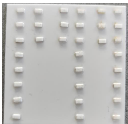
Obrázek 2.12 Vzorky pro měření síly ve stříhu připájené třemi danými hustotami skelné pájky
