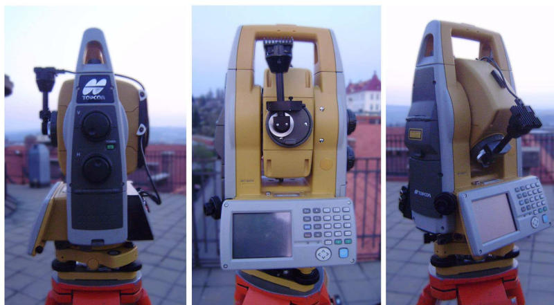
Obr. 4.1 Totální stanice GPT 9001A s instalovanou kamerou
