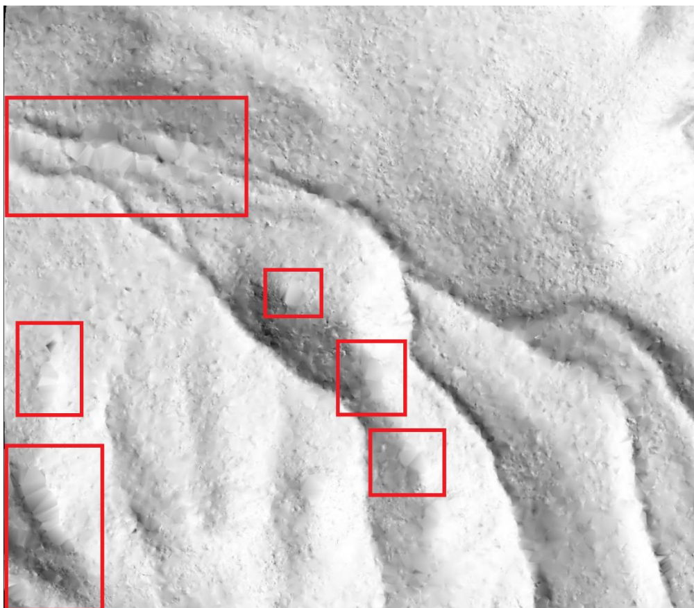
Obrázek 24 - Hillshade oblasti 1 zpracované algoritmem AG, kde vidíme digitální terénní model zatížen velkou chybou 1. druhu.
