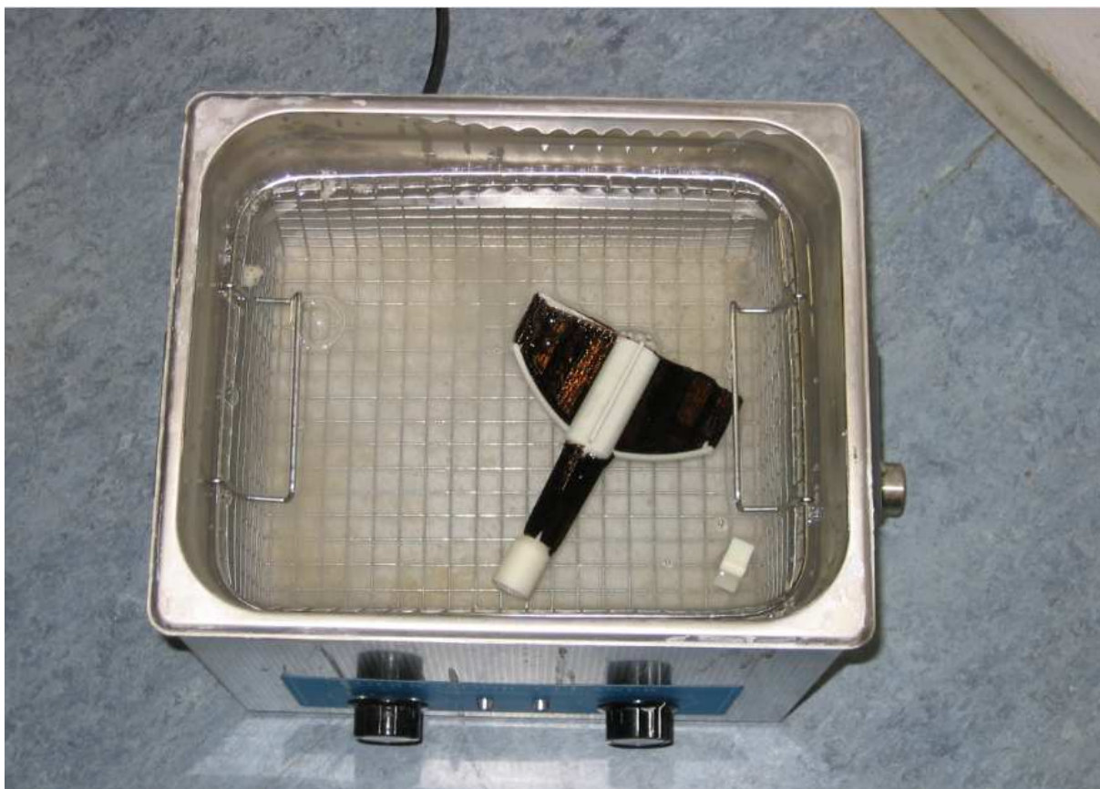
Obr. 4.8 Chemické odstraňování podpůrného materiálu
