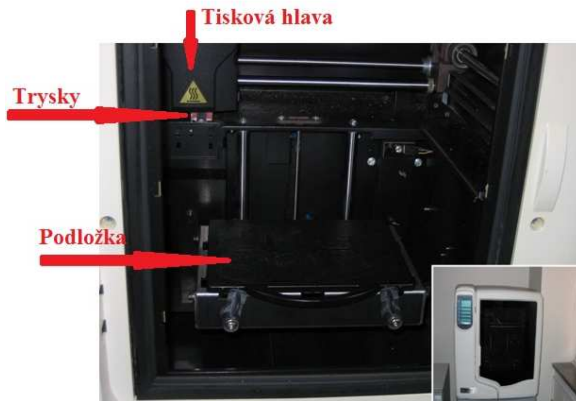
Obr. 4.6 Vnitřní modelovací prostor 3D tiskárny uPrint.
