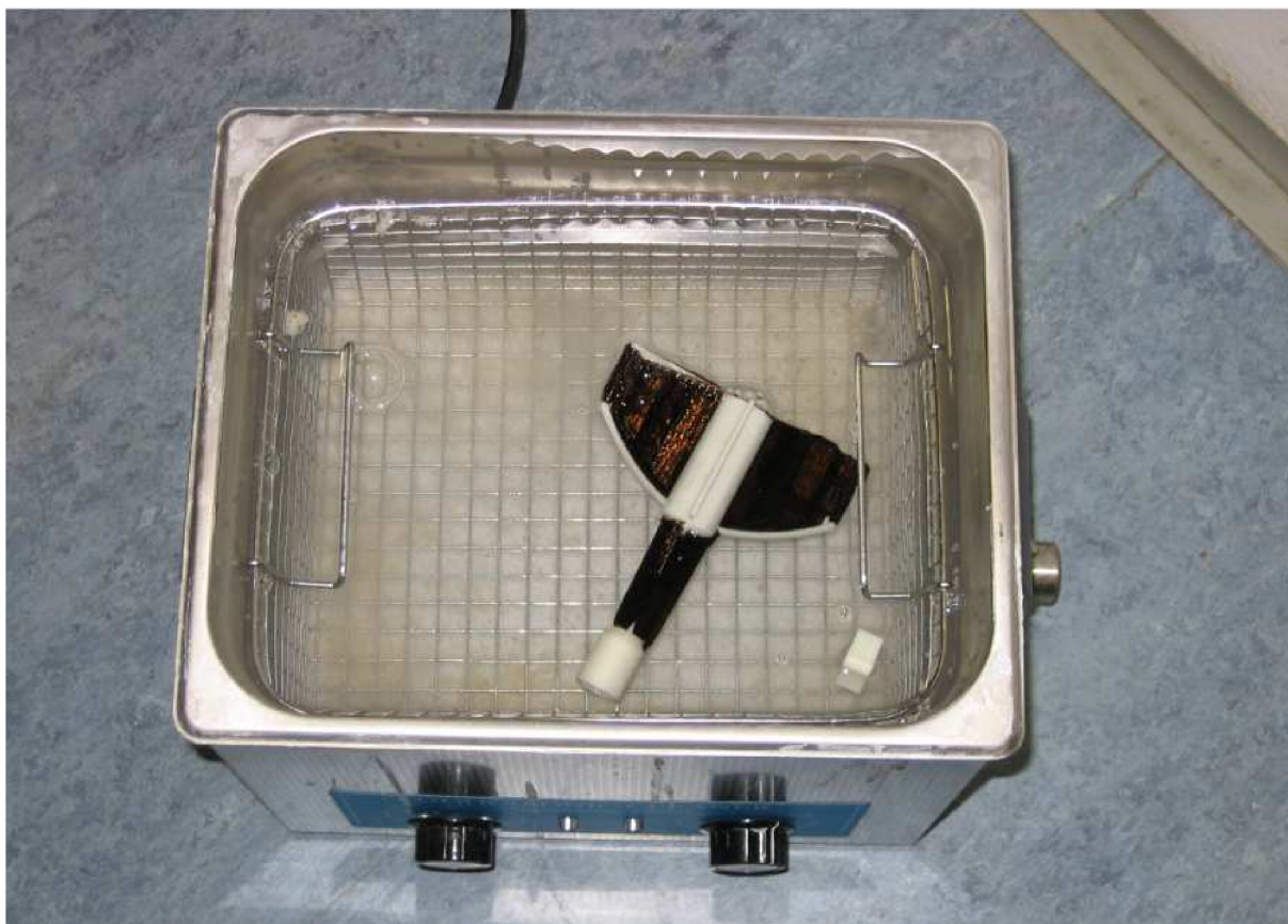
Obr. 4.8 Chemické odstraňování podpůrného materiálu
