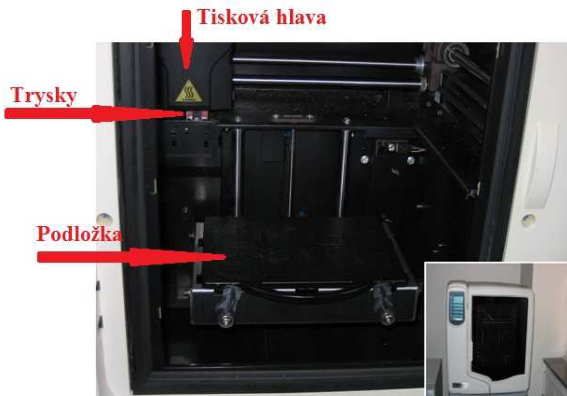
Obr. 4.6 Vnitřní modelovací prostor 3D tiskárny uPrint.
