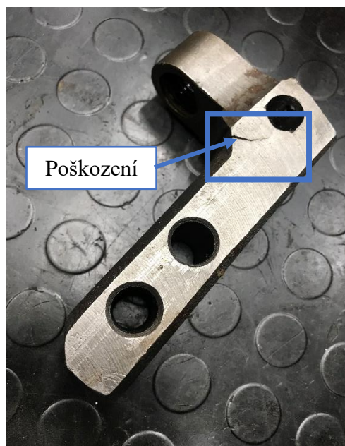
Obrázek 2.5: Poškozená součást svěráku. Foto Jan Pokorný
