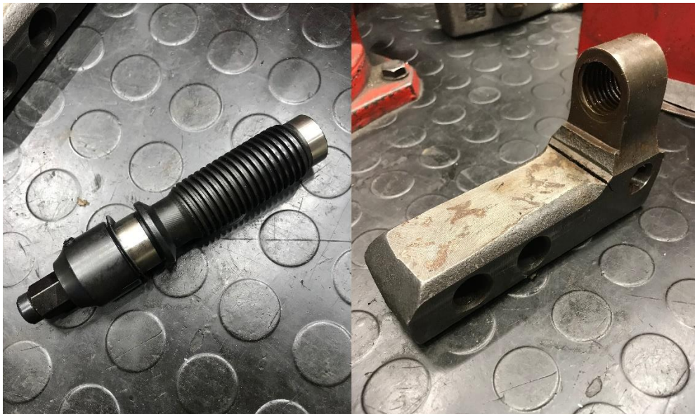
Obrázek 3.3: Poškozené díly mechanického svěráku. Foto Jan Pokorný
