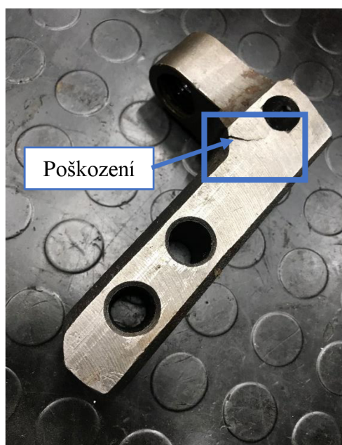
Obrázek 2.5: Poškozená součást svěráku. Foto Jan Pokorný
