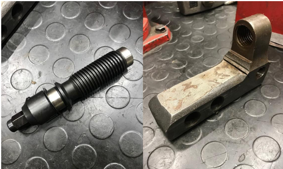
Obrázek 3.3: Poškozené díly mechanického svěráku. Foto Jan Pokorný
