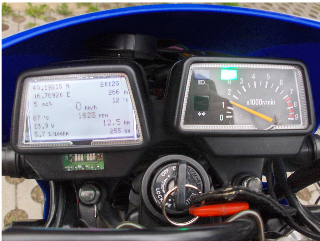
Obr. 4.1: Pohled na palubní počítač po testovací jízdě namontovaný na motocyklu
