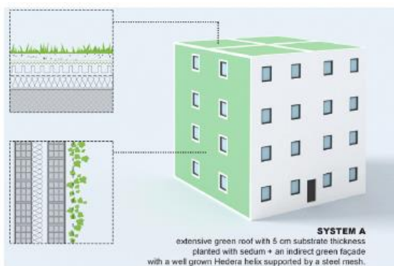
Obr. 13 Systém A: extenzivní zelená střecha a nepřímá zelená fasáda (Perini et al., 2016).
