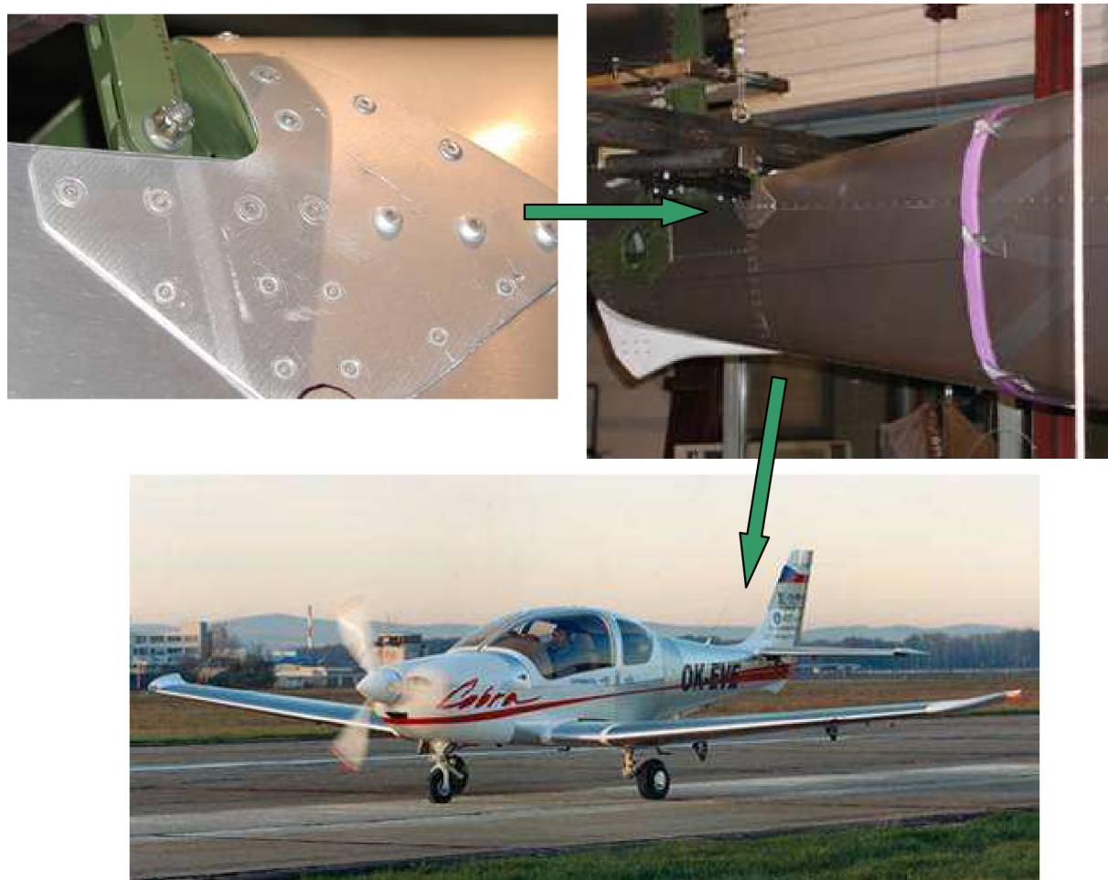
Obr. 1.4 Príklad použitia kombinácie trňových nitov a polyuretánového lepidla na VUT-100
