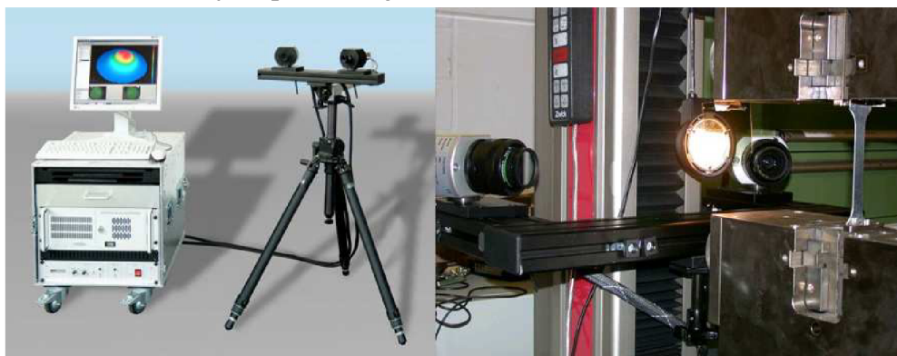
Obr. 4.13 Ilustračná fotografia ťahovej skúšky zaznamenávanej systémom Aramis
