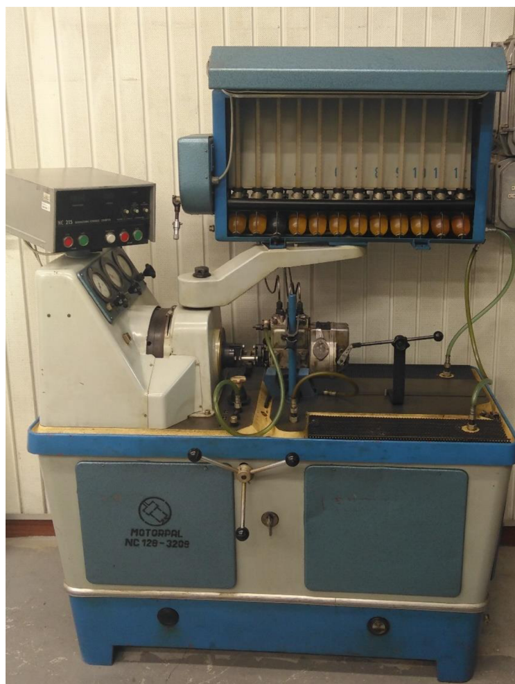
Obr. 14 Zkušební stanice Motorpal NC 128-3208
