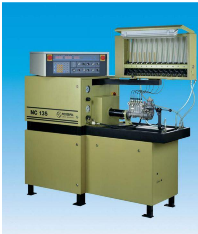
Obr. 11 Zkušební stanice Motorpal NC 135 [11]
