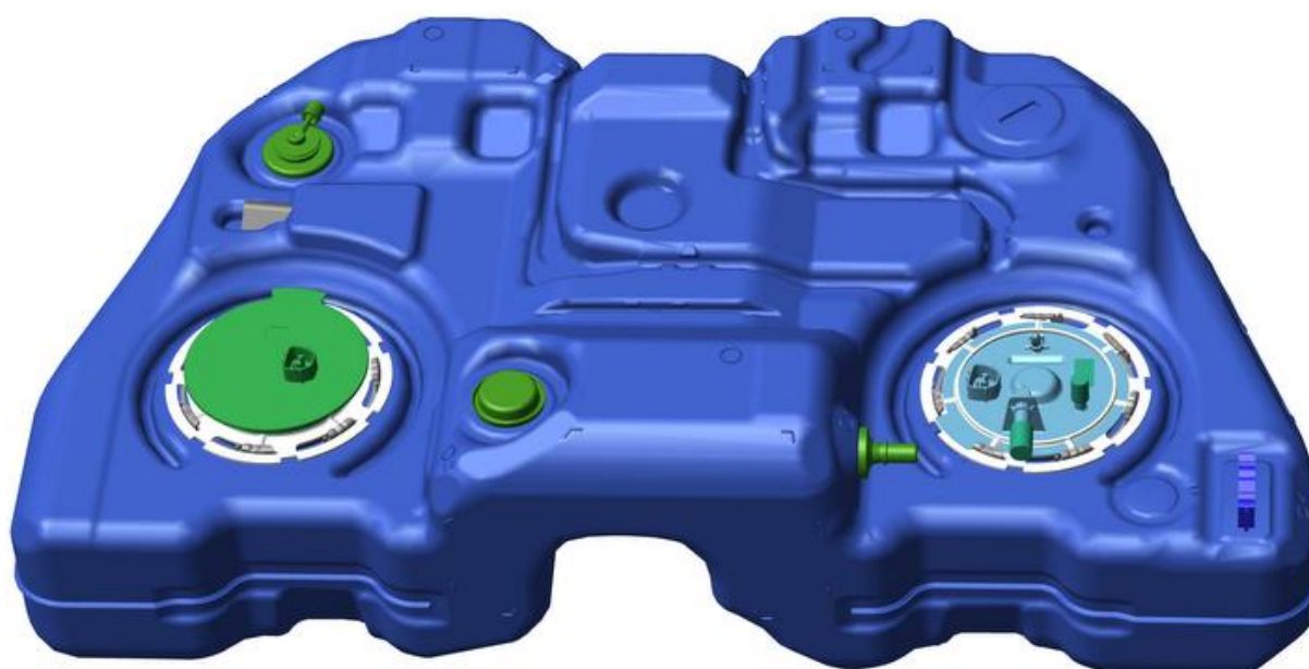
Obr. 1 Palivová nádrž vozu VW se zabudovanými palivovými moduly
