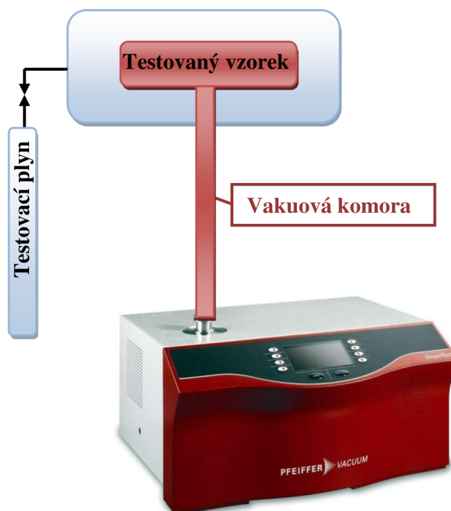
Obr. 17 Princip zkoušky: vnikání helia do vakua
