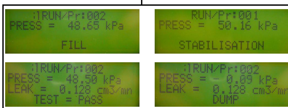
Obr. 25 ukazuje A) průběh zkoušení těsnosti přírub B) měřicí zařízení ATEQ C) vizualizace průběhu zkoušky na testovacím zařízení: Plnění = FILL, Stabilizace = STABILISATION, Měření = TEST, Vypouštění = DUMP.
