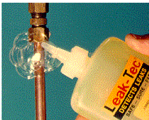
Obr. 13 Zobrazení netěsnosti pomocí emulze
