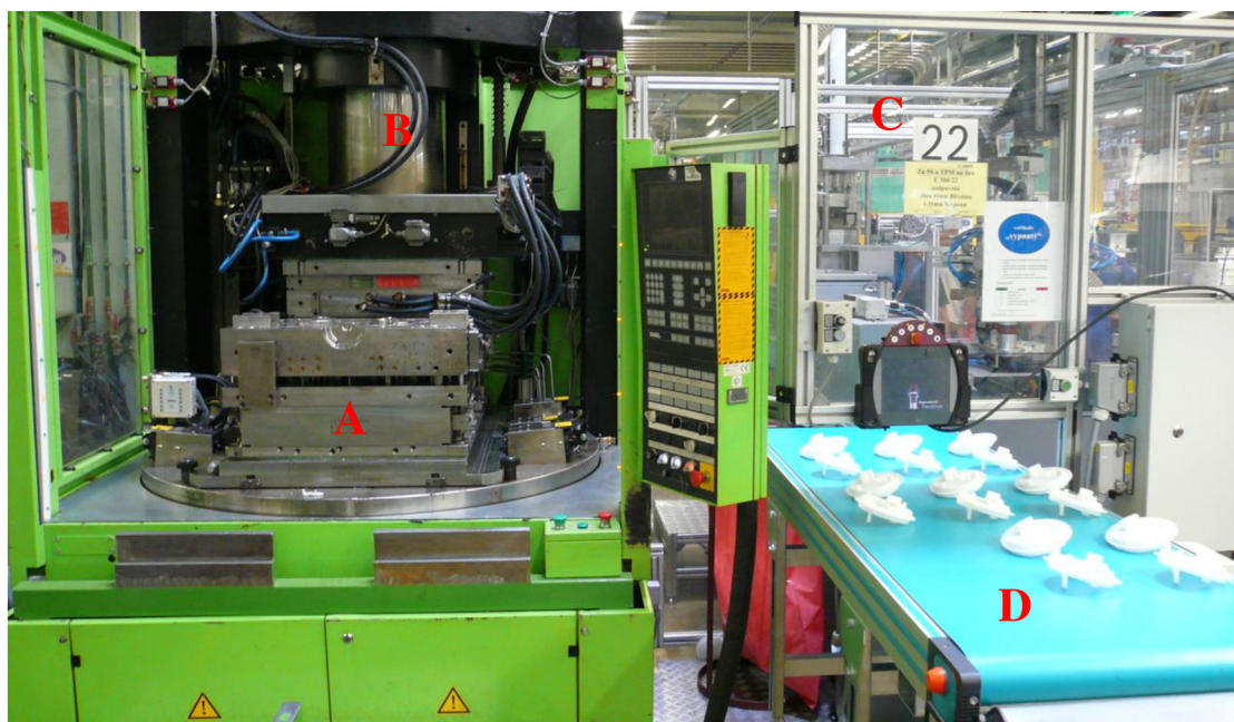
Obr. 22 Vstříkolis s vyhazovačem a stříhacím automatem, a) dvou kavitová vstříkovací forma, b) hydraulický vstříkolis, c) stříhací automat, d) pásový dopravník
