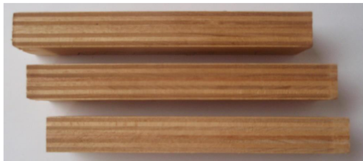
Obr. 4.7 Ukázka vzorků nařezaných na formátovací pile pro měření kvality povrchu na přístroji Talysurf CLI 1000
