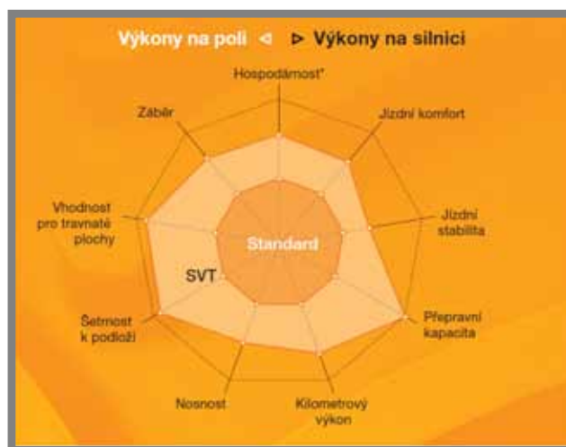
Obr. 5.7 Vlastnosti pneumatik Continental SVT [51]
