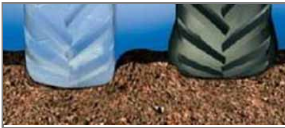
Obr. 1.32 Porovnání stopy různě huštěných pneumatik
