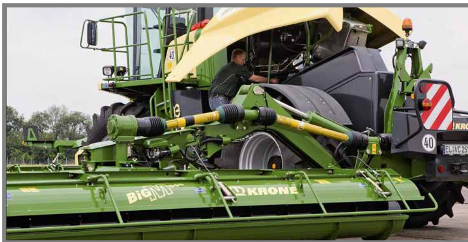
Obr. 1.26 Rozvod síly přes kardanové hřídele [36]
