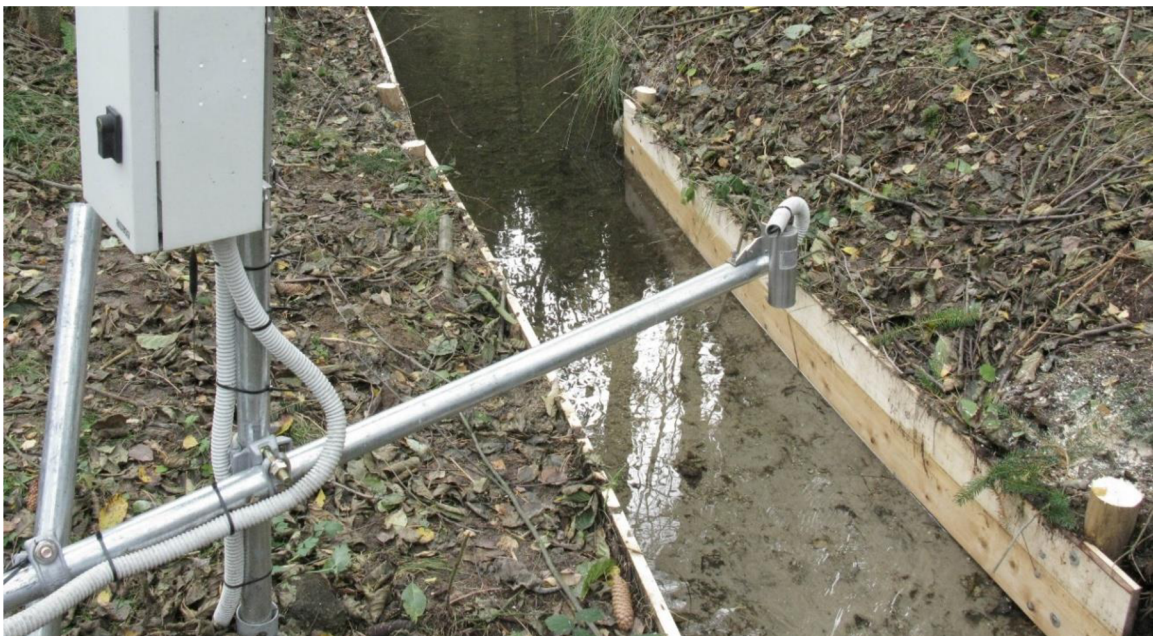
Obr. 16: Měření rychlosti proudění v korytu vodní vody v námi zvoleném profilu (průřezu).
