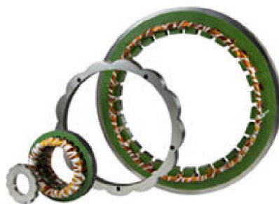
Obrázek 12: Reluktanční resolver. Převzato z [25]
