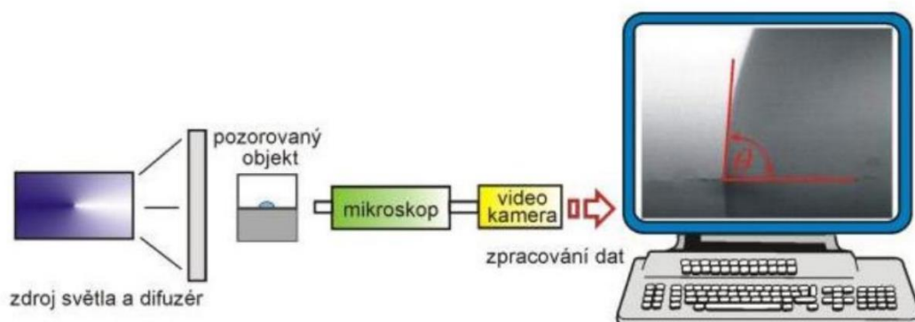
Obrázek 12 – Aparatura k měření kontaktního úhlu pomocí přisedlé kapky (Holub, 2010)
