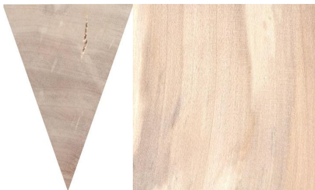
Obrázek 3 – Makroskopická stavba vrby: vlevo příčný řez, vpravo podélný řez (Mendelu, 2023)
