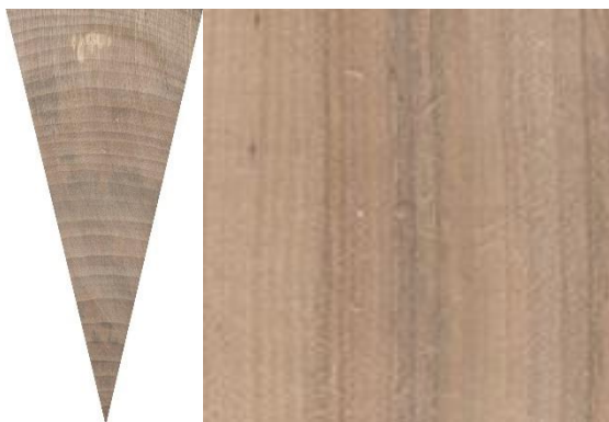
Obrázek 4 – Makroskopická stavba jeřábu ptačího: vlevo příčný řez, vpravo podélný řez (Mendelu, 2023)
