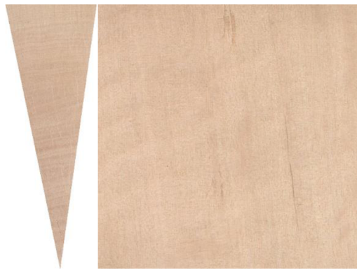
Obrázek 2 – Makroskopická stavba olše lepkavé: vlevo příčný řez, vpravo podélný řez (Mendelu, 2023)
