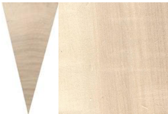
Obrázek 1 – Makroskopická stavba topolu osiky: vlevo příčný řez, vpravo podélný řez (Mendelu, 2023)
