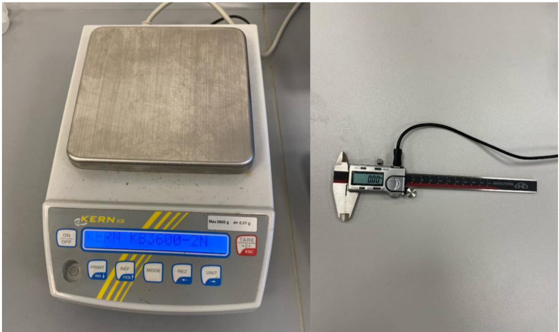
Obrázek 15 – Laboratorní váha KERN KB3600 – 2N a digitální posuvné měřítko KINEX ABSOLUTE ZERO (autor)
