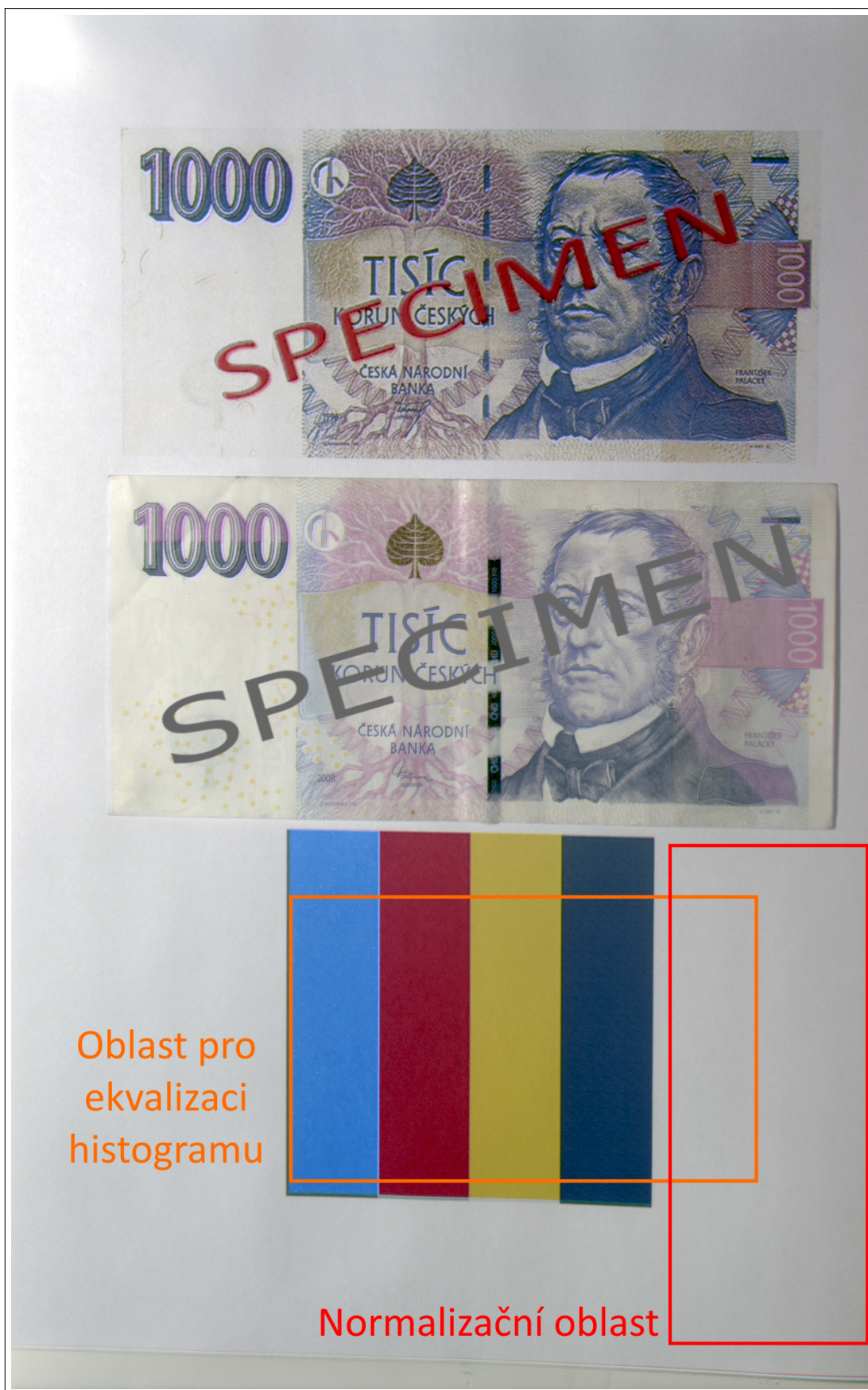
Příloha 3: Snímek reálné bankovky a kopie z laserové tiskárny pořízený pomocí interních RGB filtrů kamery, upraven pro lepší kontrast a barevnou věrnost, s vyznačenými oblastmi, které byly využity v procesu normalizace (znehodnoceno dle specifikace ČNB)
