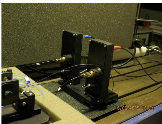
Obrázek 40. pohled na sestavené detektory zapojené podle schéma zapojení 1
