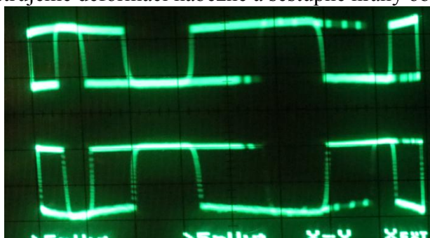
Graf 15 Linearizovaný Lissajusův obrazec při modulaci obdélníkovým signálem o frekvenci 200 Hz
