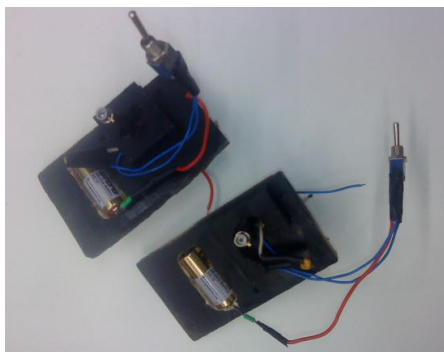
Obrázek 39. Pohled na vnitřní uspořádání detektorů při konstrukci zapojené podle schéma zapojení detektorů (viz obrázek 37)
