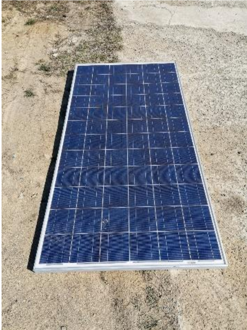
Obr. 33: Snímek zkoumaného solárního panelu MY280-P, na bázi polykrystalického křemíku
