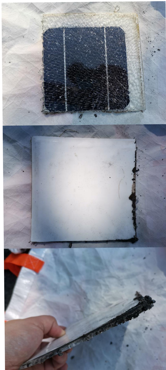
Obr. 17: Segment solárního panelu rozřezaný uhlovou bruskou
