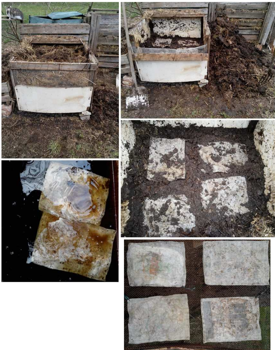
Obrázek č. 20 Vyjmutí vzorků po uplynutí 12 měsíců (ZLOCH, 2015)
