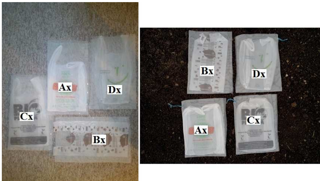
Obrázek č. 16 Příprava vzorků pro zkoušku rozpadu v domácích podmínkách kompostování - jejich vložení do obalu (ZLOCH, 2015)
