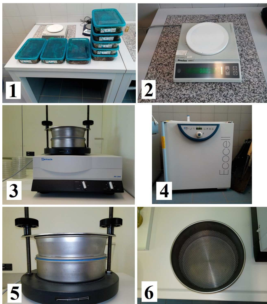
Obrázek č. 7 Laboratorní vybavení; 1 - plastové reaktory, 2 - digitální váha, 3 - vibrační síto, 4 - sušička, 5 - nádoby na přesávaný materiál - součást vibračního síta, 6 - pohled na síto (2 mm) (ZLOCH, 2015)
