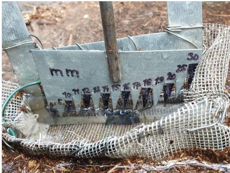
Obr. 6: Kovový systém hrotů pro odečet výšky výtopy (foto autor)
