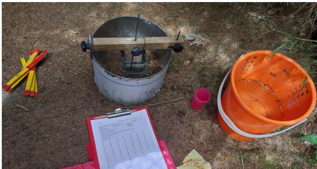
Obr. 4: Jednoválcová metoda měření infiltrace (foto autor)
